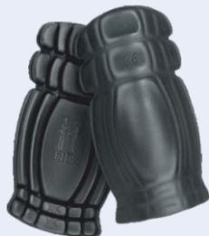
Knieschutz Typ 2, Leistungsstufe 1, DIN EN 14404. Material: 80% Ethylvinylacetat, 20% Polyethylen. 42 g leicht. Dauerhaft weich und elastisch. Geringe Druckverformung. Passt sich ergonomisch dem Knie in jeder Position an. Farbe: anthrazit. Universalgröße: 285 x 175 x 15 mm. Passend für alle FHB-Hosen mit Knietaschen.
